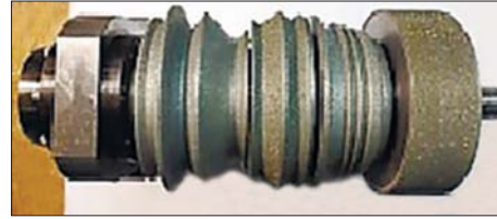
Рис. 3. Виготовлені в Інституті надтвердих матеріалів ім. В.М. Бакуля НАН України дослідні зразки правлячих алмазних роликів для глибинного шліфування
