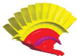
Рис. 1. Розрахункова модель сектора біметалевого диска турбіни для технології зварювання, розробленої в Інституті електрозварювання ім. Є.О. Патона НАН України
