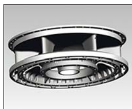
Рис. 2. 3D-модель корпусної деталі для сімейства двигунів AI-450, що планується виготовляти з високоміцного алюмінієвого ливарного сплаву розробки Інституту металофізики ім. Г.В. Курдюмова НАН України
