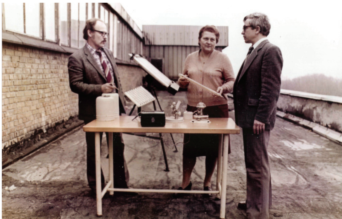
Кандидати фіз.-мат. наук А.І. Марченко, С.Ю. Повелець і В.М. Комащенко на даху Інституту проводять натурні випробування розроблених сонячних батарей (виготовлені спільно з СКТБ ІФН НАНУ 1977 р.)
